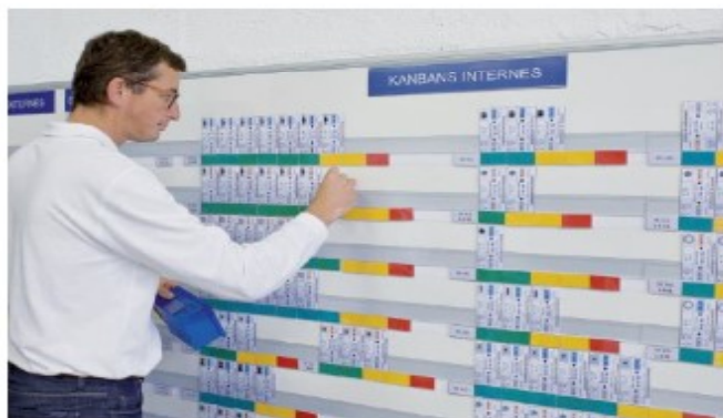
La méthode kanban permet de gérer au mieux les stocks afin de faciliter une production en flux tendus.
